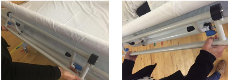
Bild 5.2 – Arbetsposition (under vändning) Rullen på ena sidan vänds från en position längst ned till positionen längst upp
